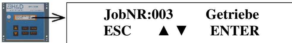
Nach ENTER wird der Job gestartet, nach ESC wird das Untermenü verlassen.
