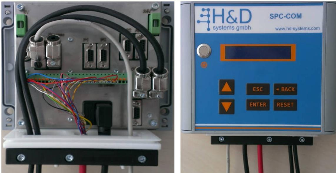
**Abb.: 3-4 SPC-COM mit der Kabeldurchführung im ausgebauten Zustand und im Montierten Zustand.**
