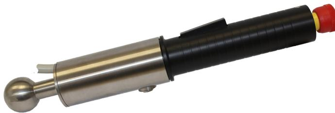
**Funktion** Durch den Druck auf den Handgriff oder den Zug des Handgriffs nach oben, entsteht eine Durchbiegung des Biegebalkens im Inneren des Handgriffs. Die DMS erfassen die Durchbiegung und leiten die Informationen in Form von elektrischen Signalen an die Auswerteelektronik. Die Auswerteelektronik verarbeitet die Signale und erzeugt PWM-Steuersignale. Die Pulsweite ändert sich proportional zur ausgeübten Belastung auf den Handgriff.
